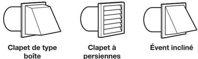
Le clapet de décharge doit se trouver à au moins 12 po (305 mm) au-dessus du sol ou de tout autre objet susceptible de se trouver sur le trajet de l'air humide rejeté (par exemple, fleurs, roches, buissons ou neige).
