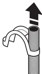
Plier le tuyau de vidange pour le mettre au contact de la bride de retenue du tuyau de vidange, et emboîter l'autre extrémité de la bride sur le tuyau.
