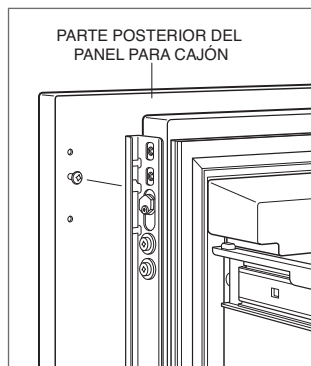
Montaje del panel del cajón
