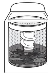
La lavadora está diseñada y optimizada para proporcionar una limpieza profunda con menos agua a fin de conservar la energía y los recursos. A medida que la lavadora moje y mueva la carga, el nivel de los artículos se asentará en la canasta. Esto es normal y no indica que se deban agregar más prendas. **IMPORTANTE:** No observará una canasta llena de agua, como en las lavadoras antiguas y menos eficientes. Es normal que parte de la carga quede por encima del nivel de agua.
