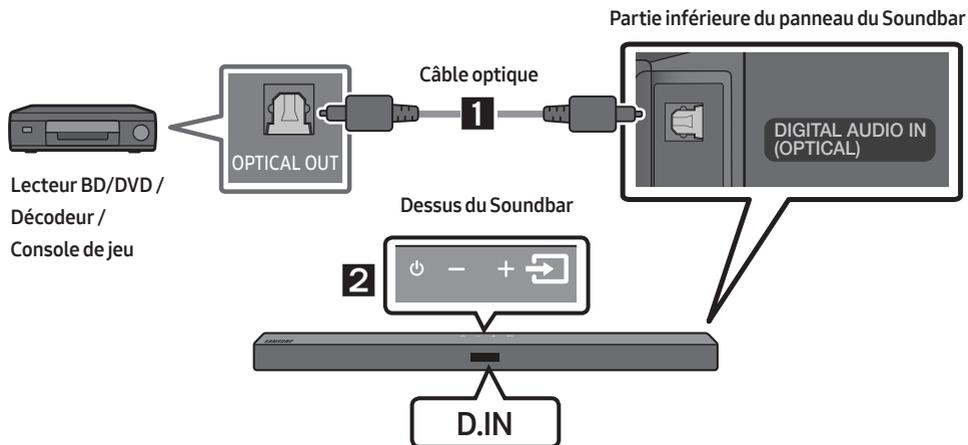
1. Branchez le connecteur **DIGITAL AUDIO IN (OPTICAL)** de l'unité principale sur le connecteur OPTICAL OUT du périphérique source à l'aide d'un câble optique numérique.
