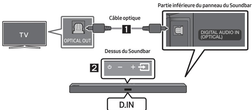
1. Branchez le connecteur **DIGITAL AUDIO IN (OPTICAL)** du Soundbar sur le connecteur OPTICAL OUT du téléviseur avec un câble optique numérique.
