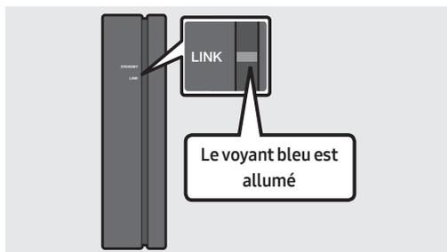
Le voyant LINK cesse de clignoter et s'allume en bleu fixe lorsqu'une connexion est établie entre le Soundbar et le module récepteur sans fil.
