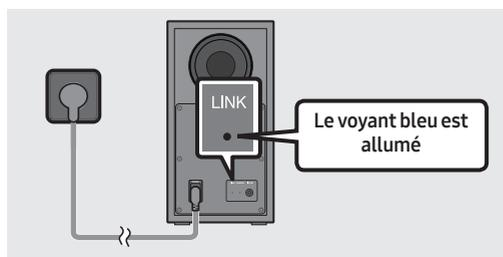
Le voyant LINK cesse de clignoter et s'allume en bleu fixe lorsqu'une connexion est établie entre le Soundbar et le caisson de basses sans fil.
