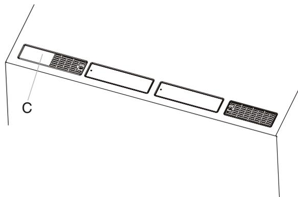
3. Retirer les couvercles d'évent situés dans la partie supérieure en mousse polystyrène (voir le point J de la section "Pièces fournies").
