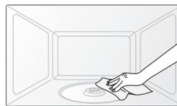
3. Insérez l'anneau de guidage préalablement assemblé dans l'empreinte située au centre du four.
