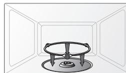
4. Déposez le plateau en verre sur l'anneau, en veillant à le positionner correctement.
