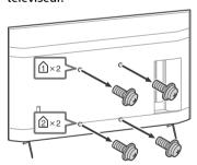
2 Installez l'accessoire de fixation murale (fourni avec le téléviseur) à l'arrière du téléviseur (de manière à ce qu'il soit parallèle au mur).
