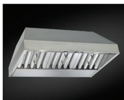
Ce design inclut le revêtement d'armoire, le ventilateur, les commandes, l'éclairage et le volet anti-retour pour une installation facile dans les armoires sur mesure.
