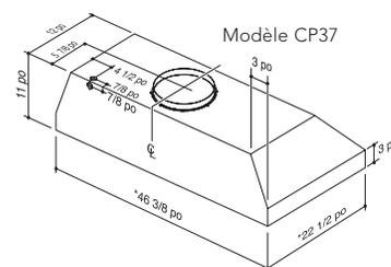
Hauteur d'installation recommandée au-dessus de la surface de cuisson : de 24 à 30 po
