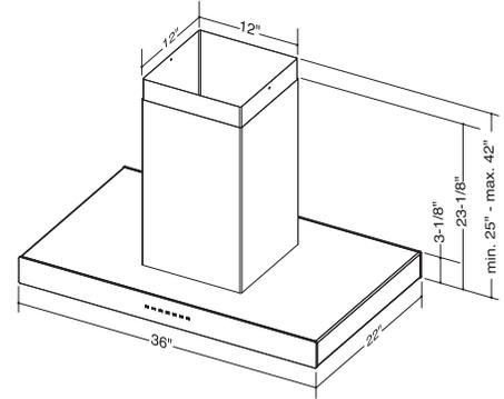
Hauteur d'installation recommandée au-dessus de la surface de cuisson : de 24 à 36 po
