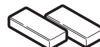
Bloques de relleno o pedazos de madera, si son necesarios para rellenar el gabinete (usados solamente en la instalación de gabinetes apoyados)
