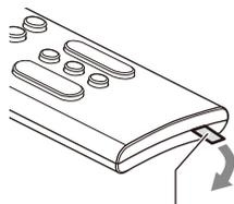
Languette isolante de la pile
