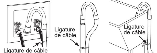
**NOTE :** Placer le tuyau de vidange trop en bas du conduit d'évacuation peut causer un siphonage. Il ne doit pas y avoir plus de 18 cm de tuyau dans le conduit d'évacuation. Il doit y avoir un espace d'air autour du tuyau de vidange. Un ajustement trop serré peut causer un siphonage.
