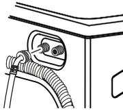
4. Si les rondelles grillagées pour flexibles ne sont pas déjà insérées dans les flexibles d'admission d'eau, insérez-les dans les extrémités libres des flexibles d'eau CHAUDE et FROIDE en orientant la face bombée vers le robinet.
