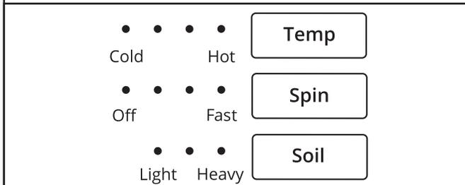
Les témoins lumineux DEL indiquent les réglages par défaut correspondant au programme sélectionné. Pour modifier un réglage, toucher le bouton correspondant – Temp (température), Spin (essorage) ou Soil (saleté). Ajuster les réglages peut changer la durée estimée restante. Il est possible que la laveuse prolonge le programme si les vêtements sont tassés ou la charge déséquilibrée, ou si la quantité de mousse produite est excessive.
