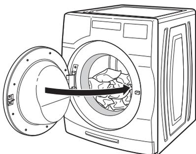
Placer une charge de linge trié dans la laveuse sans les tasser. Les articles doivent pouvoir se déplacer librement pour un nettoyage optimal et pour réduire le froissement et l’emmêlement. Fermer la porte de la laveuse en la poussant fermement jusqu’à ce que le loquet émette un clic.
