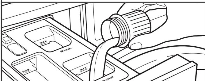
Verser une mesure de l'assouplissant de tissu liquide dans le compartiment d'assouplissant de tissu liquide. Toujours suivre les instructions du fabricant pour connaître la quantité d'assouplissant de tissu adéquate en fonction de la taille de la charge.
