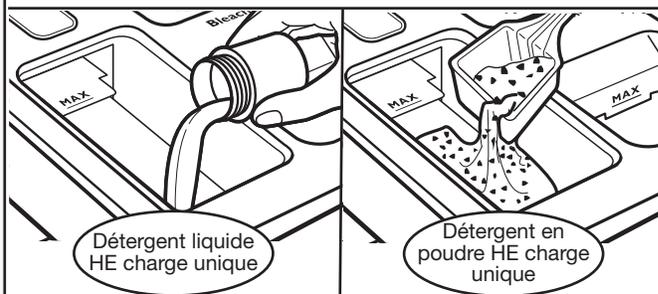
Ajuster le sélecteur en fonction du type de détergent HE utilisé (liquide ou en poudre). Ajouter une mesure de détergent directement dans le compartiment à détergent. Voir la section “Utilisation des distributeurs”.
