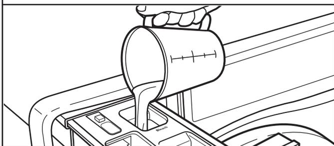
Verser l'eau de Javel dans le compartiment pour eau de Javel. Ne pas remplir excessivement le distributeur, diluer le produit ou utiliser plus de 2/3 tasse (165 mL). Ne pas utiliser de javellisant non décolorant ni de produit Oxi avec un programme utilisant de l'eau de Javel.
