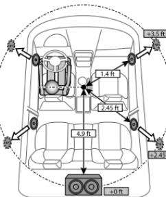
Si vous spécifiez la distance à partir de la position d'écoute actuellement réglée pour n'importe quelle enceinte, le temps de retard est calculé automatiquement.
