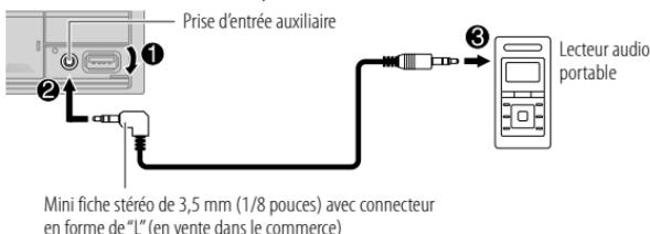
Mini fiche stéréo de 3,5 mm (1/8 pouces) avec connecteur en forme de "L" (en vente dans le commerce)
