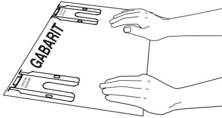
pour un montage sur le plancher. Marquez l'emplacement des trous des vis indiqués sur le gabarit.
