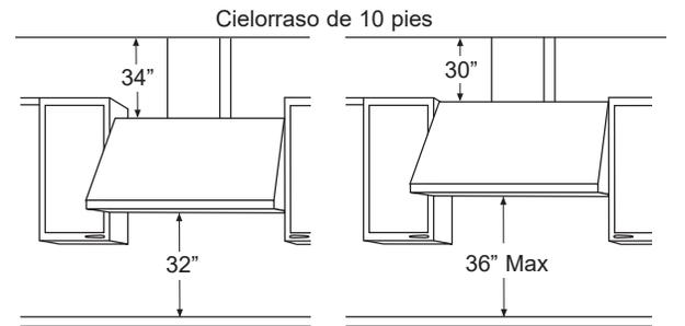
**Cielorraso de 10 pies:** Instale la campana a un mínimo de 32" y hasta un máximo de 36" sobre la superficie de cocción. La tapa del conducto se expandirá hasta un máximo de 34" sobre la parte superior de la campana hasta llegar al cielorraso.
