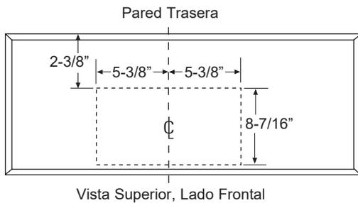
Corte un agujero de 10 3/4" x 8 7/16" a través de la parte inferior del sofito o del gabinete para la transición del conducto, como se muestra.
