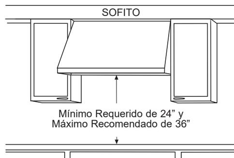
En esta instalación, el conducto que va desde la parte superior de la campana quedará escondido por el soffito o los gabinetes superiores.
