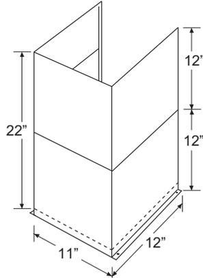
**A fin de evitar brechas antiestéticas, planifique la altura de instalación de la campana para uso con la tapa del conducto.**
