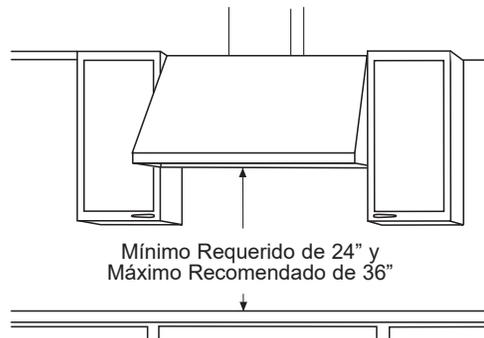
Para esta instalación, una tapa decorativa para conducto está disponible para esconder el conducto que va desde la parte superior de la campana. El uso de la tapa del conducto requiere una consideración especial en relación a la altura de la instalación sobre la mesada. Para más detalles, consulte la página 12.
