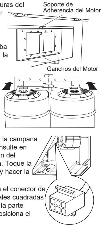
**IMPORTANTE:** Sostenga el conector de modo que las dos terminales cuadradas de las esquinas estén en la parte superior, a medida que posiciona el conector para enchufarlo.
