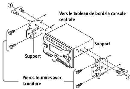
Si vous installez cet appareil sur les supports préinstallés de votre véhicule, faites passer les vis fournies ① par les trous de vis appropriés, en fonction de votre véhicule :
