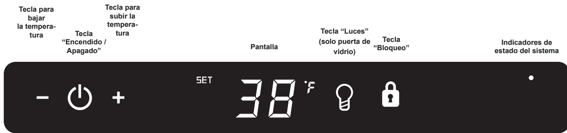
Figura 10 Control electrónico para una sola zona
