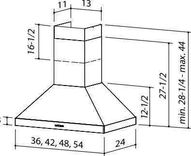
Hauteur d'installation recommandée au-dessus de la surface de cuisson : de 24 à 36 po
