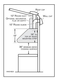
MODEL P12 DUAL INTERIOR BLOWER TYPICAL DUCTWORK
