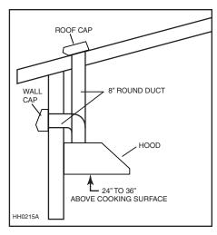
MODEL P3, P6 or iQ6 (SINGLE) INTERIOR BLOWER 8" ROUND DUCTWORK
