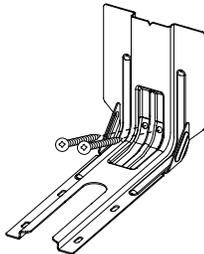
5. À l'aide des deux vis à tête Phillips n° 10 x  $1\frac{1}{4}$ " (4,1 cm) fournies, visser la bride antibasculément au mur ou au plancher.
