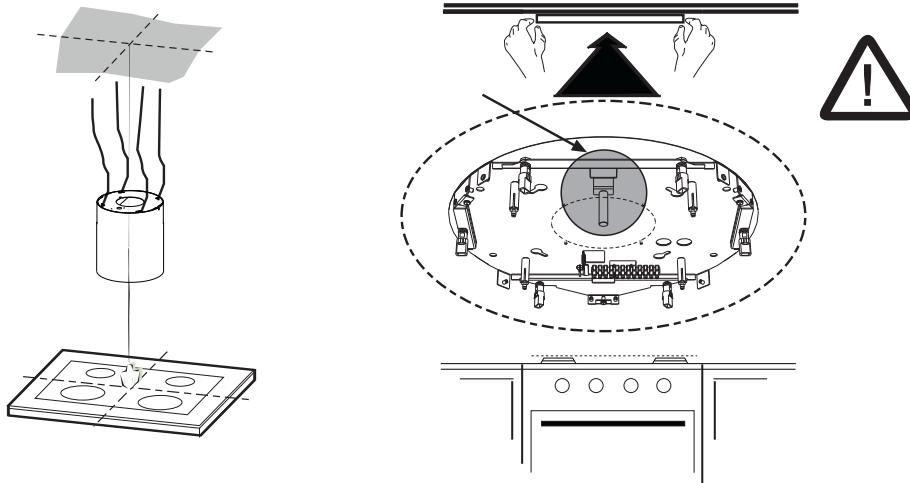
Utilice una plomada y marque el centro de la placa de cocción en el techo de soporte.
