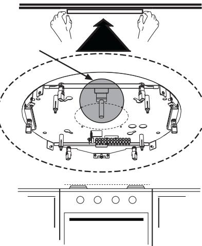
En utilisant un fil à plomb, marquez sur le plafond l'emplacement du centre de la surface de cuisson.
