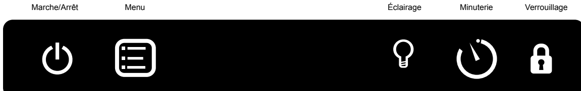
Figure 10: Affichage sur l'interface pour utilisateur durant une coupure d'alimentation.
