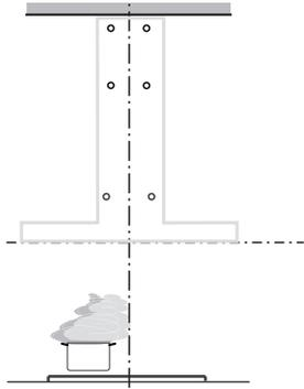
Les vis d'installation fournies doivent être renforcées par des chevilles (achetées séparément).
