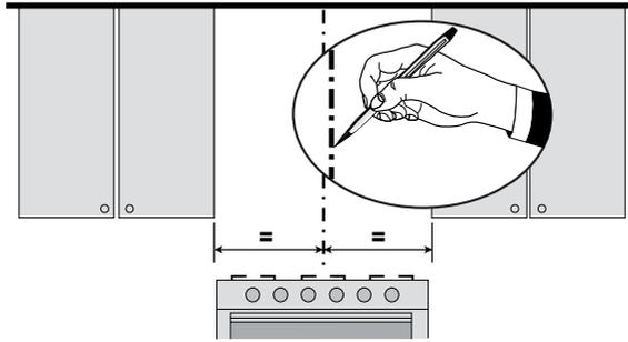
Tracez une ligne verticale sur le mur d'appui le plus haut que possible, au centre de l'emplacement où la hotte sera installée.
