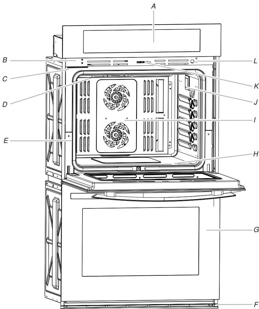
A. Module de commande électronique du four
