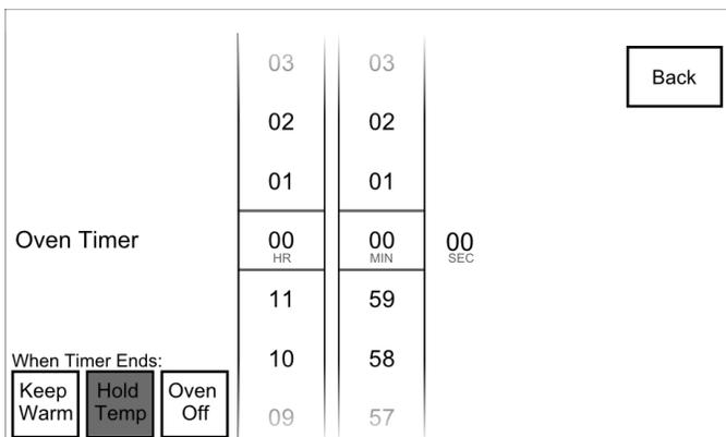
Le réglage Keep Warm™ abaisse la température du four à 170°F (77°C) après que le temps de cuisson s'est écoulé. Hold Temp (maintenir la température) maintient la température du four réglée après que le temps de cuisson s'est écoulé. Oven Off (four éteint) éteint le four une fois que le temps de cuisson s'est écoulé.
