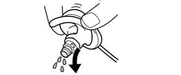
• Ne laissez pas l'appareil recouvert d'eau dans des endroits froids car l'eau peut geler. Pour éviter tout dysfonctionnement, veillez à essuyer l'eau après utilisation.
