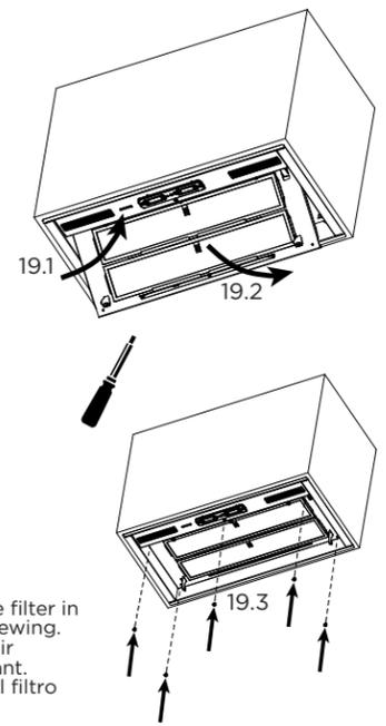
NOTE: Hold the filter in place when screwing. NOTE: Maintenir le filtre en vissant. NOTA: Sujete el filtro atornillándolo.
