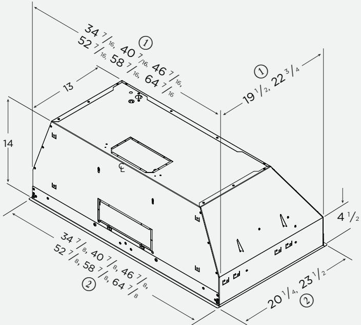
**Note :** les dimensions ci-dessus prennent en compte l'utilisation des quatre bordures autour de la hotte. **Les bordures avant et arrière peuvent être retirées. Les bordures latérales ne peuvent pas être retirées.**
