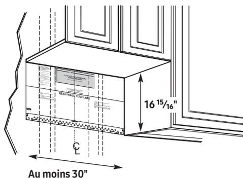
Tracez un trait vertical sur le mur du fond, au centre de l'espace de 30" de large. Fixez le gabarit du fond au mur afin que la partie supérieure du gabarit touche la partie inférieure du cadre du meuble et que le trait central du gabarit soit aligné avec la ligne que vous avez tracée sur le mur.
