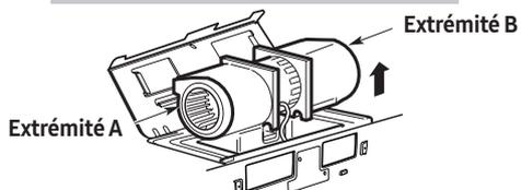
**ATTENTION :** afin d'éviter la rupture ou la fissure des ailettes du ventilateur, ne les touchez pas. Tenez fermement le carénage extérieur du ventilateur lorsque vous le retirez ou le remettez en place.
