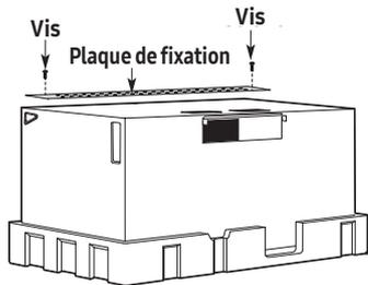
5. Retirez les 2 vis de la plaque de fixation. Cette plaque est utilisée comme gabarit du mur du fond et pour le montage.
