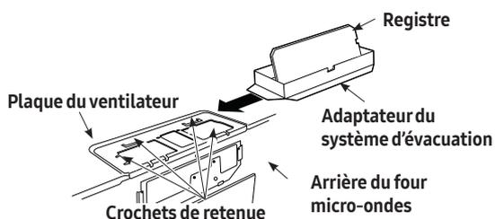
1. Faites glisser l'adaptateur du système d'évacuation conformément au schéma ci-dessus.
