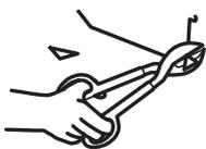
\* **IMPORTANT :** si un adaptateur rectangulaire-circulaire est utilisé, les coins inférieurs du registre devront être coupés à l'aide de cisailles afin de le fixer et de permettre au registre de bouger librement.
