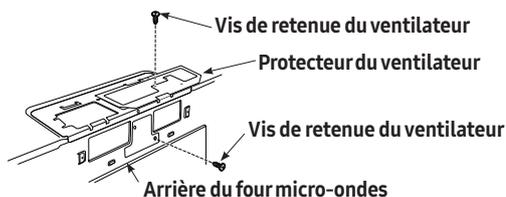
8. Faites glisser l'adaptateur du système d'évacuation situé à l'arrière du four micro-ondes, puis fixez-le en place dans les languettes de verrouillage inférieures. Assurez-vous que la charnière du registre est située dans la partie supérieure et que le registre bouge librement. Réinstallez la vis du moteur de ventilateur supérieur à travers l'adaptateur ainsi que la plaque du ventilateur à l'arrière du four micro-ondes.
