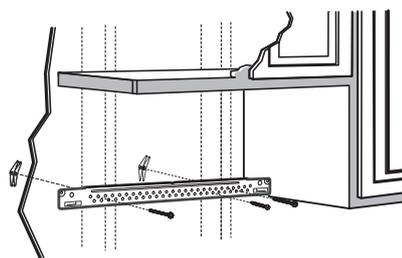
Fixez la plaque au mur à l'aide de boulons à ailettes. Au moins une vis à bois est nécessaire pour fixer la plaque à un goujon.
