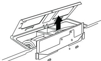
7. Fermez la porte de la ventilation. Glissez la protection de la ventilation sur le dessus de l'ouverture de la porte de la ventilation.
