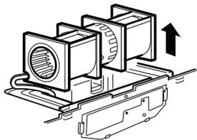
**ATTENTION :** afin d'éviter la rupture ou la fissure des ailettes du ventilateur, ne les touchez pas. Tenez fermement le carénage extérieur du ventilateur lorsque vous le retirez ou le remettez en place.
