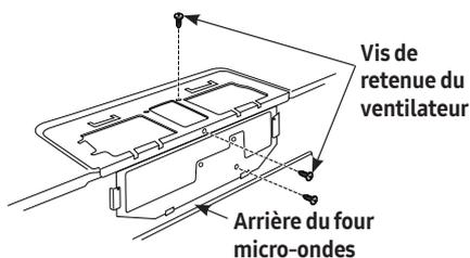
2. Ouvrez la plaque du ventilateur en la soulevant à l'arrière du micro-ondes. Retirez et mettez de côté le protecteur du ventilateur situé à l'arrière du micro-ondes en le faisant glisser vers le haut. Retirez et mettez de côté le cache métallique du ventilateur situé à l'arrière du micro-ondes en le faisant glisser vers le haut.
