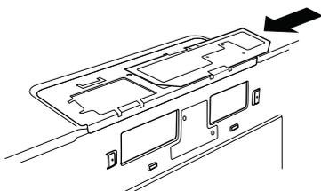
8. Fixez la ventilation sur le micro-ondes à l'aide des vis de fixation de la ventilation de l'étape 1.
