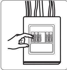
**ATTENTION :** pour votre sécurité, retirez le fusible de l'installation électrique ou ouvrez le disjoncteur avant de démarrer l'installation afin d'éviter tout risque d'électrocution.
