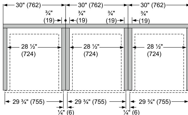
Installation côte à côté à côté standard d'affleurement
