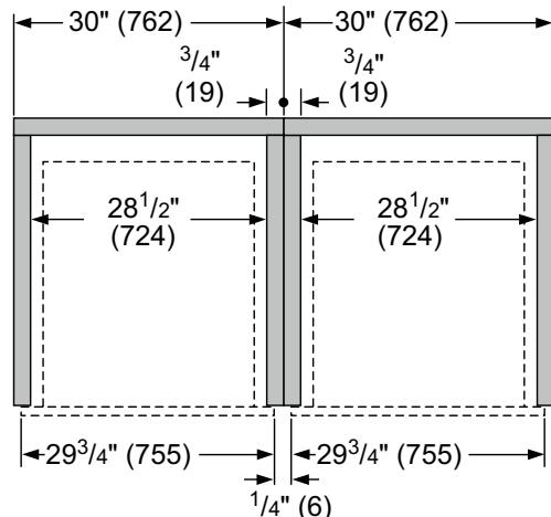
**Installation côte à côté standard d'affleurement**
