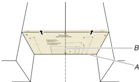
A. Bord arrière de la plaque de carton et bord arrière de l'armoire supérieure
