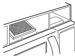
7. Glissez le fond du couvercle de ventilation en place. Poussez sur le dessus jusqu'à ce qu'il soit solidement en place. Vissez les vis de montage. Remettez la tension de la source d'alimentation principale en circuit.
