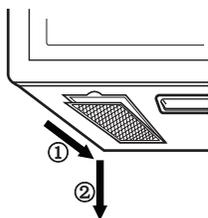
2. Faites tremper les filtres dans l'eau chaude et une solution de nettoyage douce. Rincez et secouez pour les assécher. **N'utilisez pas d'ammoniaque pour nettoyer un filtre à mailles d'aluminium et ne le lavez pas au lave-vaisselle. L'aluminium ternira.**
