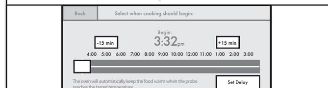
Appuyer sur les touches 15 minutes ou utiliser la barre de glissement. Le four conserve automatiquement les aliments au chaud une fois que la sonde a atteint la température cible.
