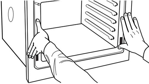
3. Pousser complètement le four dans le placard et le centrer dans la cavité d'encastrement du placard.
