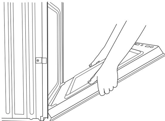
5. Saisir les bords de la porte du four avec les deux mains. Soulever et tirer la porte du four vers soi et enlever la porte. Vous devrez peut-être basculer doucement la porte d'un côté et de l'autre en la tirant.
