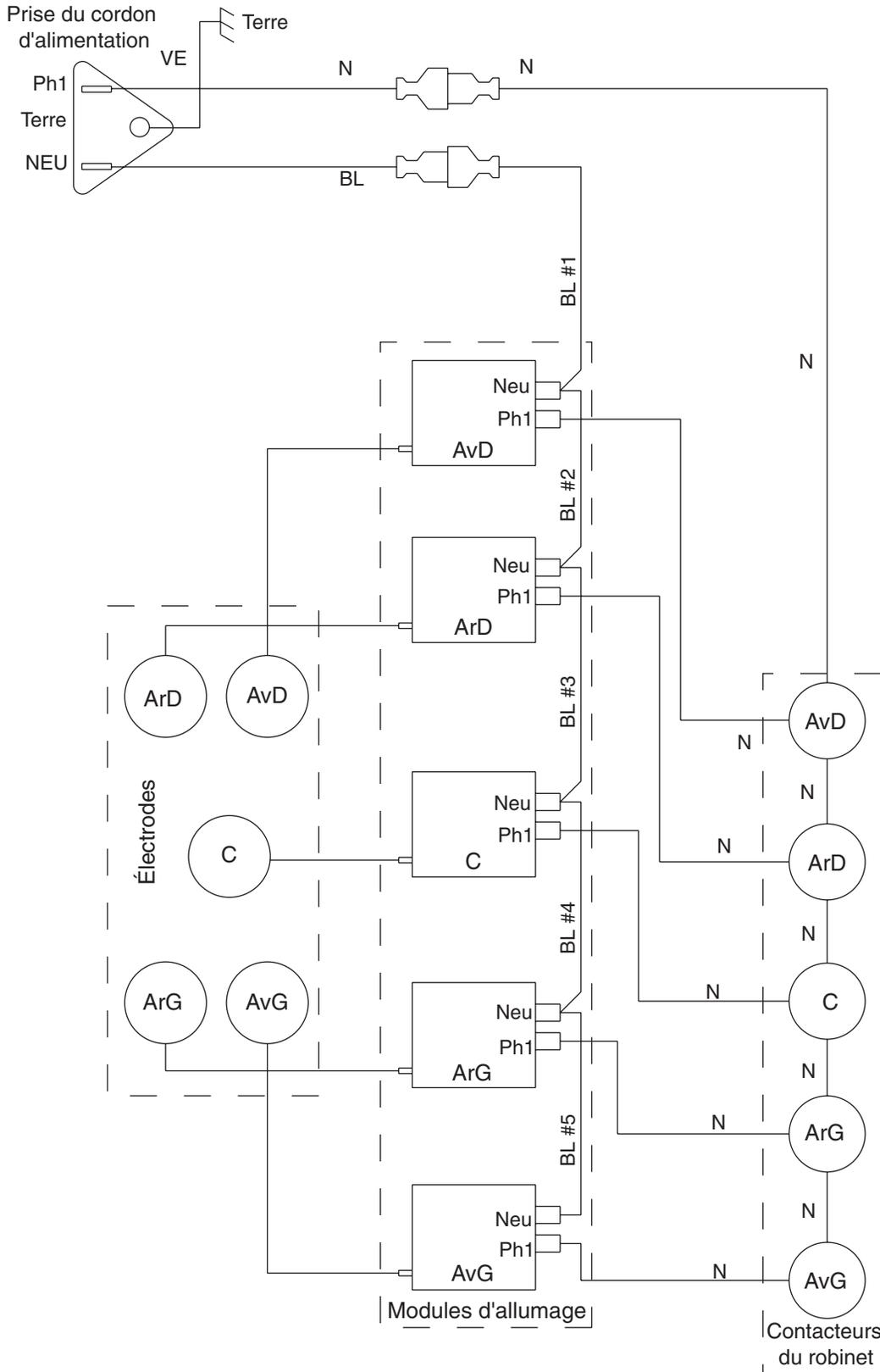
**REMARQUE :** Le circuit électrique est fermé dès que le bouton est enfoncé et tourné dans le sens anti-horaire entre 0° et 210° depuis la position d'arrêt.
