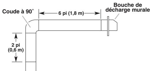
Dans l'exemple suivant, la longueur de conduit recommandée est de 35 pi (10,7 m) maximum.
