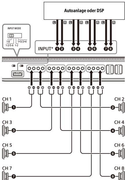
\* Stellen Sie die Verbindung mit dem Anschluss INPUT/LINE OUT über das Verbindungskabel ③ her. Erläuterungen dazu finden Sie unter „Eingangsverbindung“ (Seite 11).
