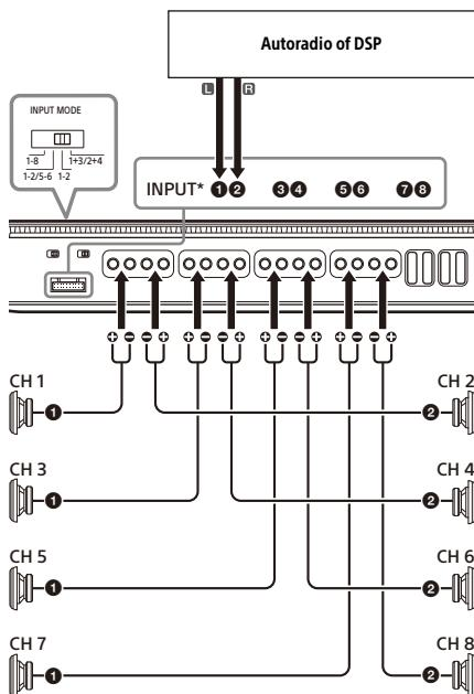
\* Gebruik de verbindingenkabel ③ om verbinding te maken met de INPUT/LINE OUT-aansluiting. Raadpleeg "Invoeraansluiting" (pagina 11) voor meer informatie.
