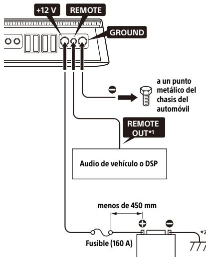
\*1 Si tiene el original de fábrica o algún sistema de audio del automóvil o DSP (procesador de señal digital) sin una salida remota para el amplificador, conecte el terminal de entrada remota (REMOTE) a la fuente de alimentación ACC. En la conexión de entrada de alto nivel, el amplificador también puede activarse sin necesidad de conexión REMOTE. Sin embargo, esta función no está garantizada en todas las unidades de audio de vehículos o DSP.
