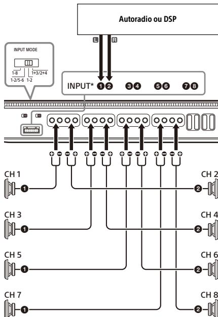
\* Raccordez au connecteur INPUT/LINE OUT à l'aide du câble de raccordement ③. Pour plus d'informations, reportez-vous à la section « Raccordement des entrées » (page 11).
