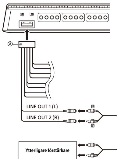
Ställ in LINE OUT MODE-omkopplaren på kontrollpanelen (övre panel) efter egna önskemål.
