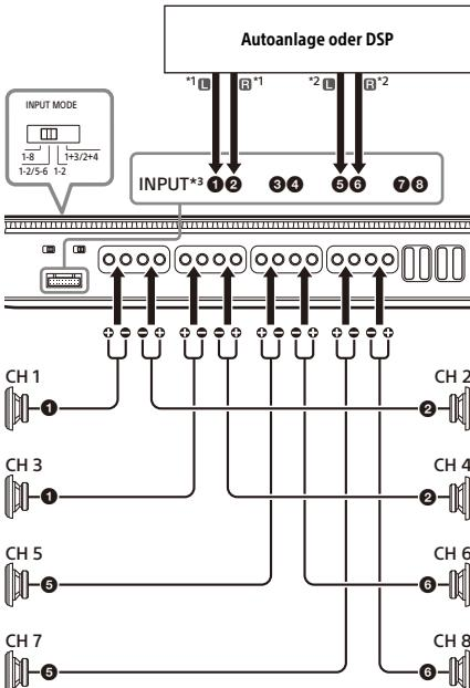
\*1 Gefiltertes Signal. Front-Audioausgabe oder HPF-Ausgabe von der Autoanlage.
