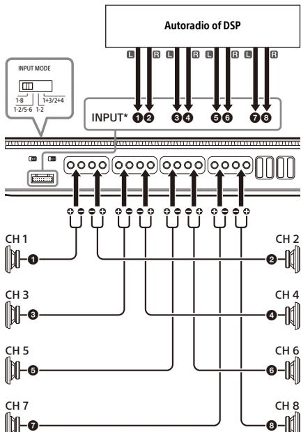
\* Gebruik de verbindingenkabel ③ om verbinding te maken met de INPUT/LINE OUT-aansluiting. Raadpleeg "Invoeraansluiting" (pagina 11) voor meer informatie.
