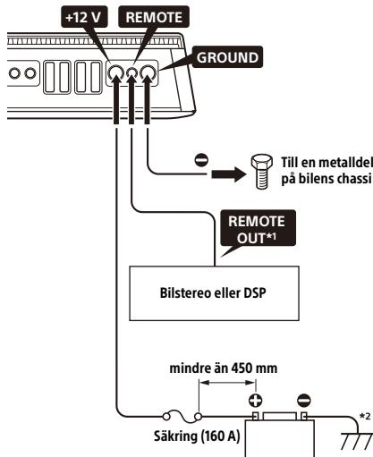
\*1 Anslut uttaget för fjärrutgång (REMOTE) till ACC-strömförseringen när du använder originalstereo eller annan bilstereo eller DSP (digital signalprocessor) utan fjärrutgång för förstärkaren. Förstärkaren kan också aktiveras utan att REMOTE-anslutning krävs vid anslutningen för hög inmatningsnivå. Denna funktion garanteras inte fungera med alla bilstereor eller DSP.
