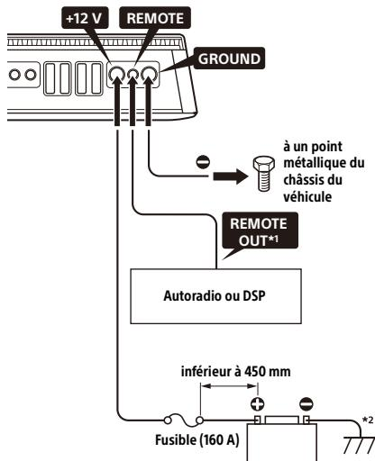
\*1 Si vous disposez de l'autoradio d'origine, d'un autre autoradio ou d'un DSP (processeur de signal numérique) dépourvu de sortie de commande à distance pour l'amplificateur, raccordez la borne d'entrée de commande à distance (REMOTE) à l'alimentation ACC. Avec un raccordement des entrées haut niveau, l'amplificateur peut également être activé sans qu'un raccordement REMOTE soit nécessaire. Néanmoins, cette fonction n'est pas garantie pour tous les autoradios ou DSP.
