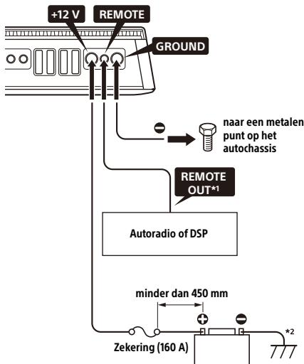
\*1 Als u een originele fabrieksautoradio of een andere autoradio of DSP (digitale signaalprocessor) zonder afstandsbedieningsuitgang voor de versterker hebt, verbindt u de afstandsbedieningsingang (REMOTE) met de ACC-voeding. Bij een hoogniveau-invoeraansluiting kan de versterker ook zonder REMOTE-verbinding geactiveerd worden. Wij kunnen echter niet garanderen dat deze functie werkt bij alle autoradio's of DSP's.
