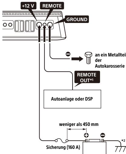
\*1 Bei der werkseitigen oder einer anderen Autoanlage oder einem DSP (digitalen Signalprozessor) ohne Fernbedienungsausgang für den Verstärker verbinden Sie den Fernbedienungseingang (REMOTE) mit der Stromversorgung für Zubehörgeräte. Bei einer Hochpegel-Eingangsverbindung kann der Verstärker auch ohne REMOTE-Verbindung aktiviert werden. Es kann jedoch nicht garantiert werden, dass diese Funktion bei allen Autoanlagen oder DSPs zur Verfügung steht.
