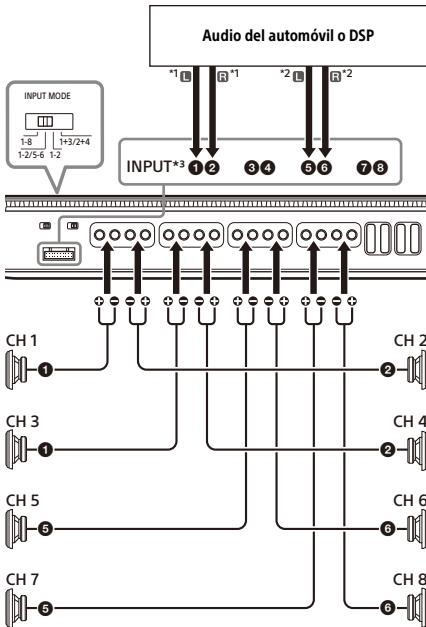
\*1 Señal filtrada. Salida de audio delantera o salida HPF desde el audio del vehículo.
