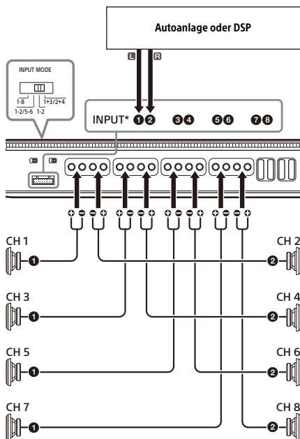
\* Stellen Sie die Verbindung mit dem Anschluss INPUT/LINE OUT über das Verbindungskabel ③ her. Erläuterungen dazu finden Sie unter „Eingangsverbindung“ (Seite 11).
