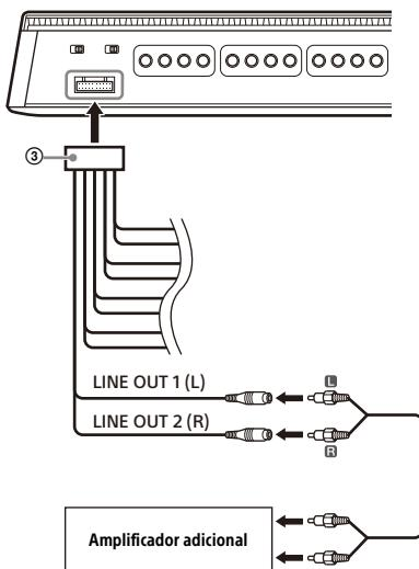
Ajuste el interruptor LINE OUT MODE del panel de control (panel superior) en función de sus necesidades.
