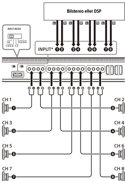
\* Anslut till INPUT/LINE OUT-anslutningen genom att använda anslutningskabeln ③. För mer information se "Ingångsanslutning" (sidan 11).
