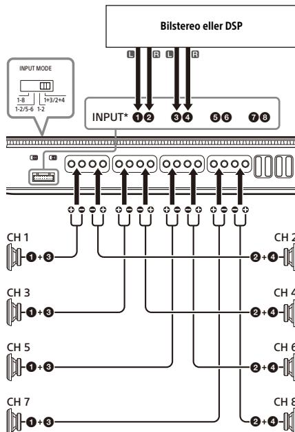
\* Anslut till INPUT/LINE OUT-anslutningen genom att använda anslutningskabeln ③. För mer information se "Ingångsanslutning" (sidan 11).
