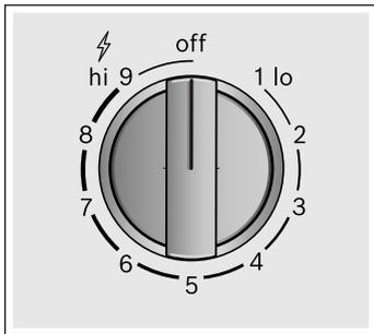
**Pour retirer le bouton :** Avec le bouton de commande à la position **ARRÊT**, soulever délicatement le bouton vers le haut pour le dégager.
