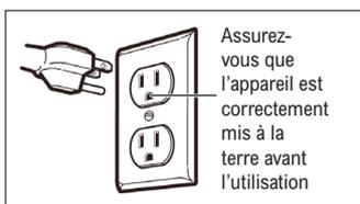
**⚠ AVERTISSEMENT** Une utilisation inappropriée de la prise de mise à la terre peut entraîner un risque de décharge électrique.
