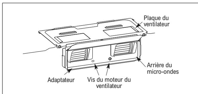
9. Vissez la plaque du ventilateur au micro-ondes avec les vis. Remplacez la plaque du ventilateur dans la même position.
