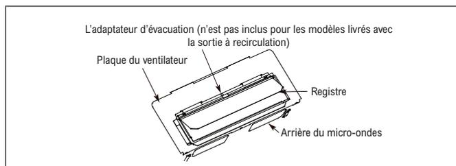
4. Fixez l'adaptateur d'évacuation à la plaque du ventilateur en la glissant dans les guides. Fixez l'adaptateur avec une vis à tôle fournie.
