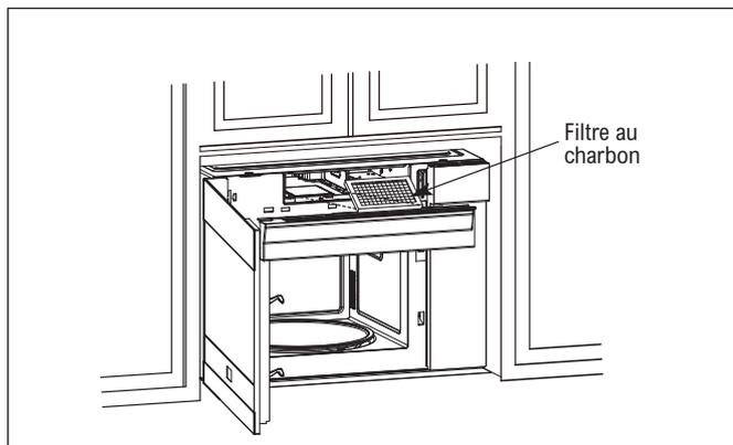
3. Installez le nouveau filtre au charbon. Lorsque correctement installé, le grillage métallique du filtre doit être visible à l'avant.
