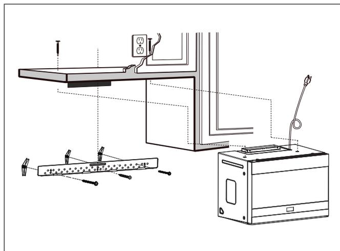
2. Placez la plaque de montage contre le mur et insérez les écrous à oreilles dans les trous du mur pour installer la plaque.
