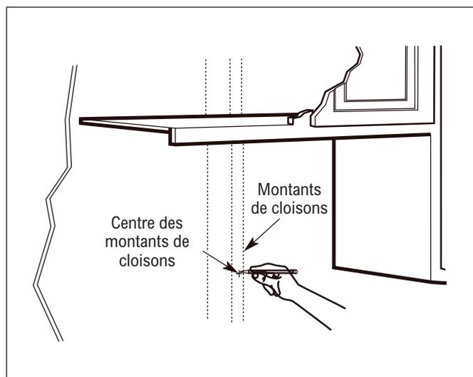
2. Après avoir localisé le(s) montant(s), trouvez le centre en pénétrant le mur avec un petit clou pour trouver les rebords du montant de cloison.
