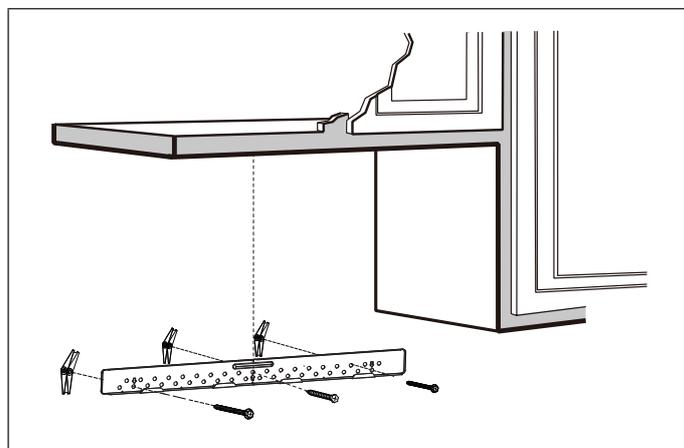
3. Serrez tous les boulons. Tirez la plaque de montage pour l'éloigner du mur pour vous aider à serrer les boulons.
