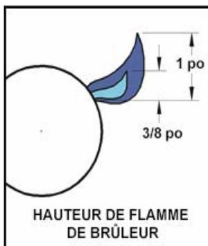
Les flammes doivent être bleues et stables sans pointes jaunes (celles des appareils au GPL auront parfois des pointes jaunes). Il ne doit pas y avoir de bruit excessif ni de « décollage » de la flamme des brûleurs. Si l'une quelconque de ces situations existe, déposer les brûleurs et rechercher la présence de crasse, de débris, de toiles d'araignées obstruant l'obturateur d'air ou les orifices de combustion. Procéder au réglage des obturateurs d'air si nécessaire.
