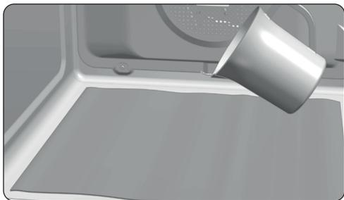
2. Versez lentement 200 ml d'eau dans la cavité inférieure du four.
