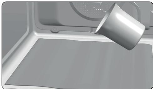
2. Verta lentamente 200 ml de água na parte inferior da cavidade do forno.
