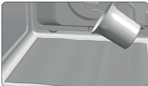
2. Vierta lentamente 200 ml de agua en la parte inferior de la cavidad del horno.
